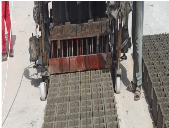
شكل 2: عملية صب الخلطة الخرسانية في القوالب.
