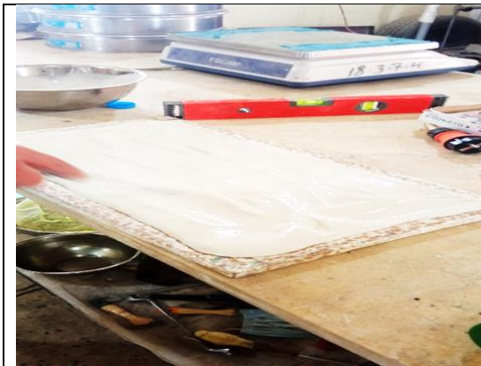
شكل 4- ب: وضع الجبس على اللوح الفولاذي
