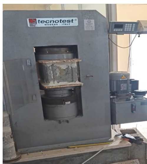
شكل 5: وضع العينة في جهاز اختبار الضغط
