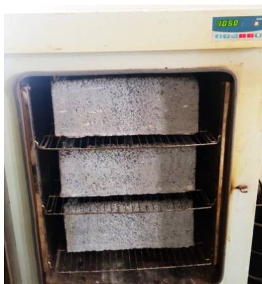
شكل 6- أ: العينات تجفف في فرن كهربائي
