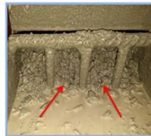
الشكل (20) يوضح اختبار L-Box test للخلطات.
