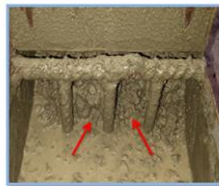
الشكل (19) يوضح نتائج اختبار J-Ring
