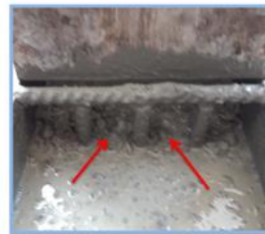
الشكل (19) يوضح نتائج اختبار J-Ring
