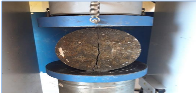
الشكل (25) يوضح طريقة اختبار مقاومة الشد.
