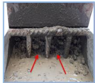
الشكل (20) يوضح اختبار L-Box test للخلطات.
