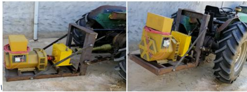
شكل 16: تركيب الملحق على الجرار وتشغيل نظام الرفع الهيدروليكي
