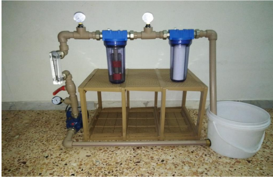
الشكل (7): الشكل النهائي لنظام إزالة الماغنيتيت
