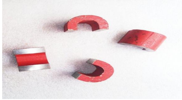
شكل (2): المغناطيس المستخدم في المصفي
