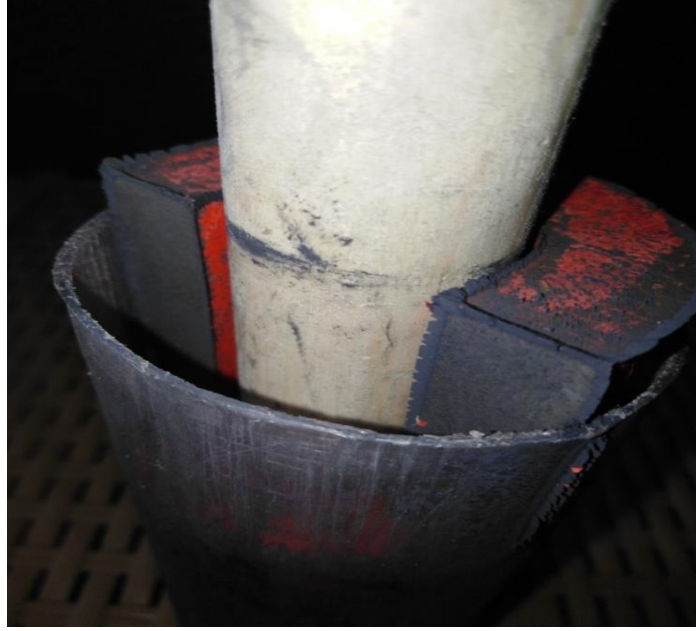
شكل (9): المغناطيس بعد التقاطه للماغنيتيت
