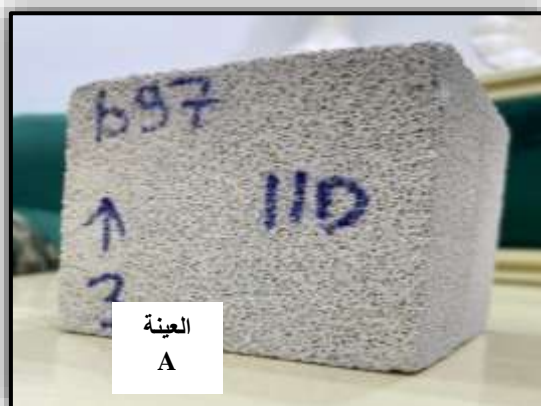
شكل (11) شكل الطوب الرملي بعد الإنتهاء من عملية التشكيل.
