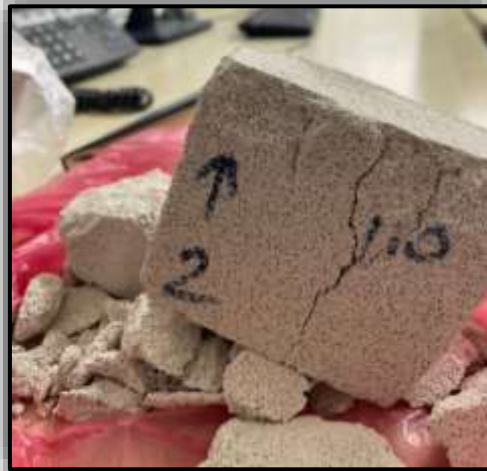
شكل (14) العينة C بعد تسليط إجهاد الضغط عليها.
