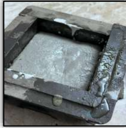
الشكل (9) يبين صب الخليط بالقوالب.
