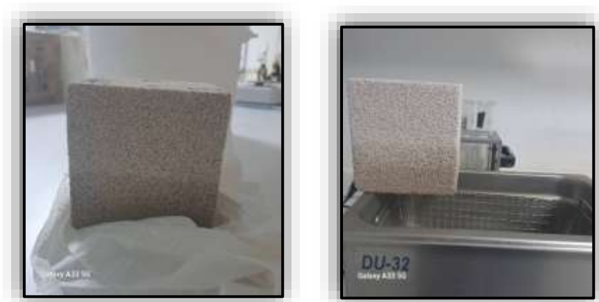
شكل (16) غسل العينة وتجفيفها بعد غمرها بالماء.
