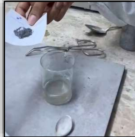
شكل (8) خلط بودرة الألومنيوم بالماء.
