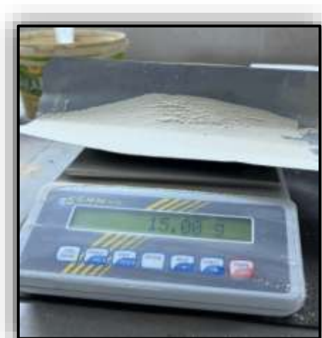
شكل (4) الجير بعد عملية النخل.
