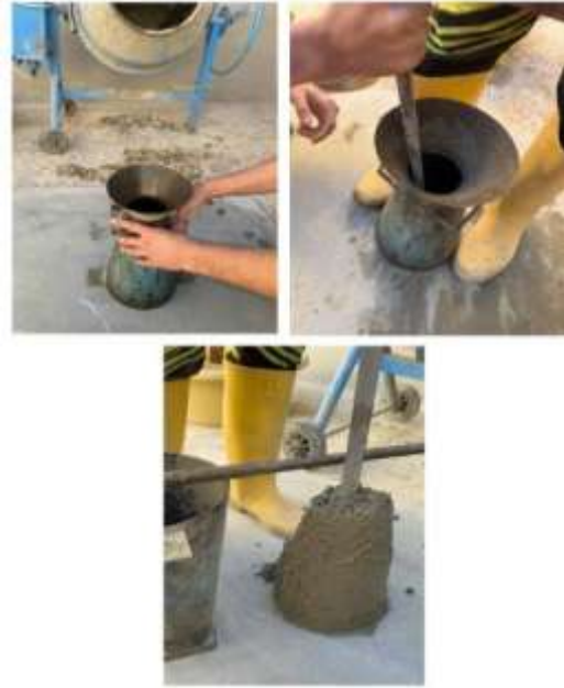
شكل (6) إجراء اختبار الهبوط للخلطات الخرسانية.
