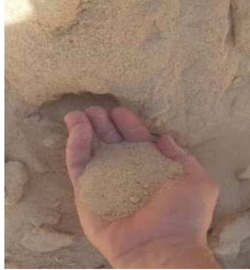
شكل (2) الفحص البصري للرمل المستخدم في الخلطات الخرسانية.
