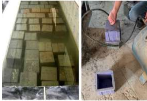
شكل (8) عملية فك القوالب وغمرها في الماء للمعالجة.
