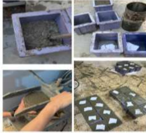
شكل (7) تجهيز العينات الخرسانية في المعمل .
