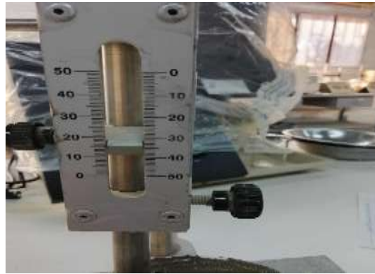
صورة رقم 2: لعينة اسمنت بني اسويف الوصول إلى زمن الشك الابتدائي.
