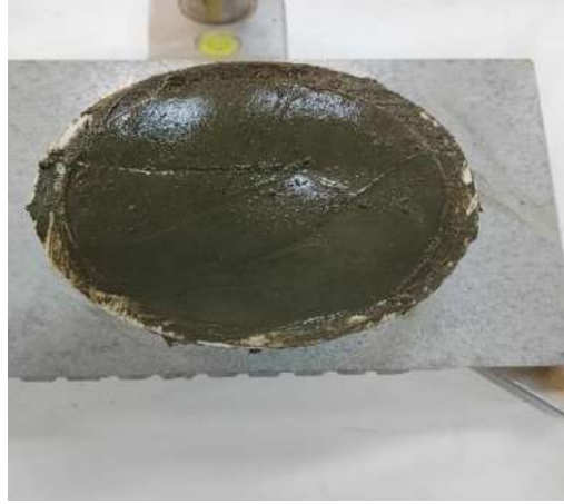
صورة رقم 1: عينة اسمنت بني اسويف في قالب جهاز فيكات.
