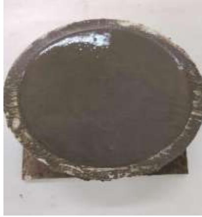
صورة رقم 3: عينة اسمنت الفتاح في قالب جهاز فيكات.
