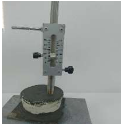
صورة رقم 4: لعينة اسمنت الفتاح الوصول إلى زمن الشك الابتدائي.
