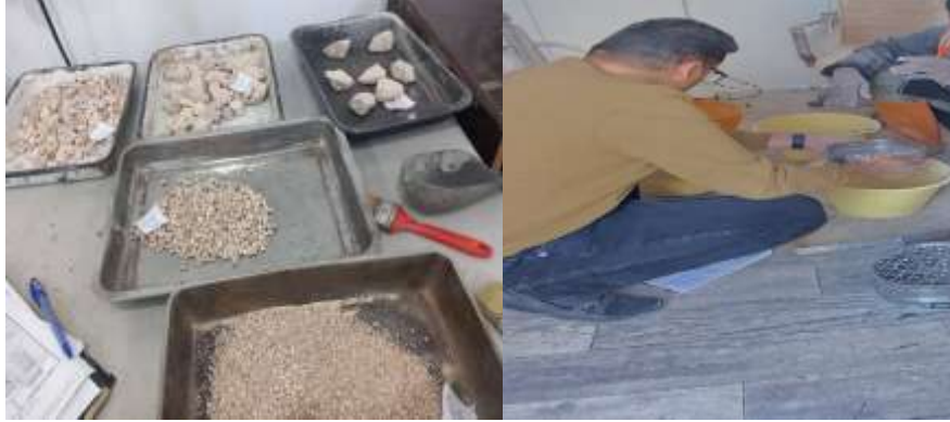
شكل 1 القيام باختبار تدرج العينة من المحجر قبل التوريد
