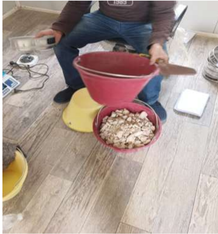
شكل (12) تجهيز العينة للقيام بالتحليل المنخل عليها
