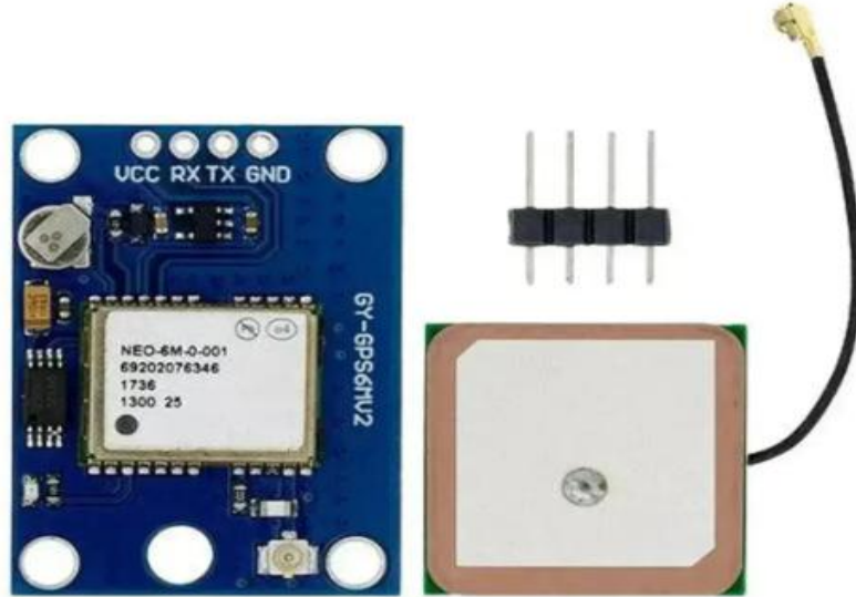
الشكل (6) يبين وحدة GPS NEO-6M المستخدمة في النظام
