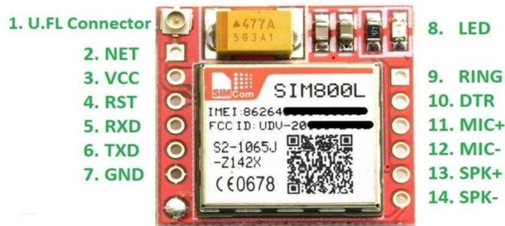
الشكل (5) يبين وحدة GSM SIM800L المستخدمة في النظام
