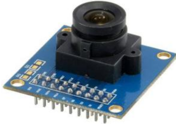
الشكل (7) يبين الكاميرا الرقمية للنظام (OV7670 Camera Module)
