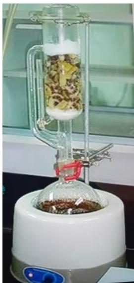
شكل (1) يوضح جهاز Soxhlet.
