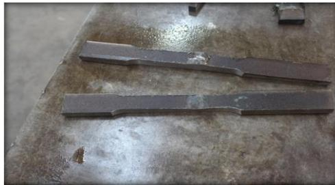
شكل 3. عينة اختبار الشد.
