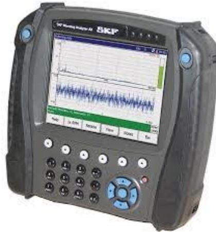
شكل 2. جهاز SKF Microlog Analyzes AX
